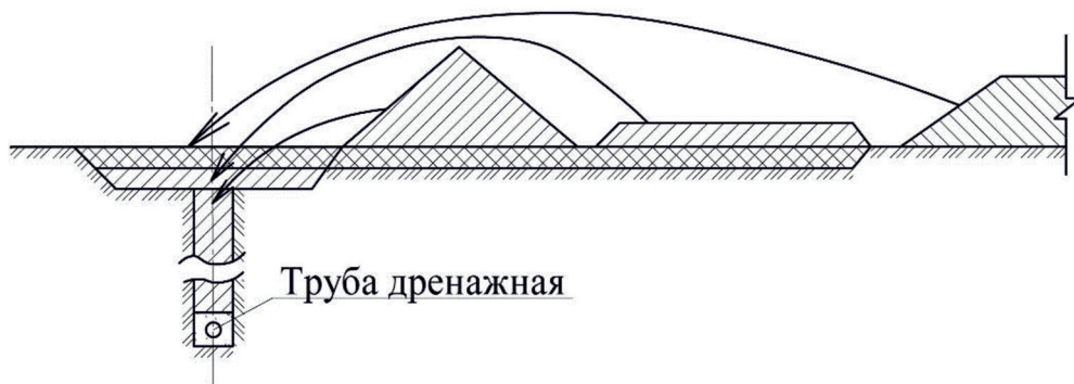
Рисунок 1 – Технологическая схема строительства закрытых дрен траншейным способом
